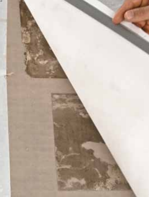
Während das Blatt auf dem Sogtisch angesaugt wird, kann man das Trägersieb abziehen.
