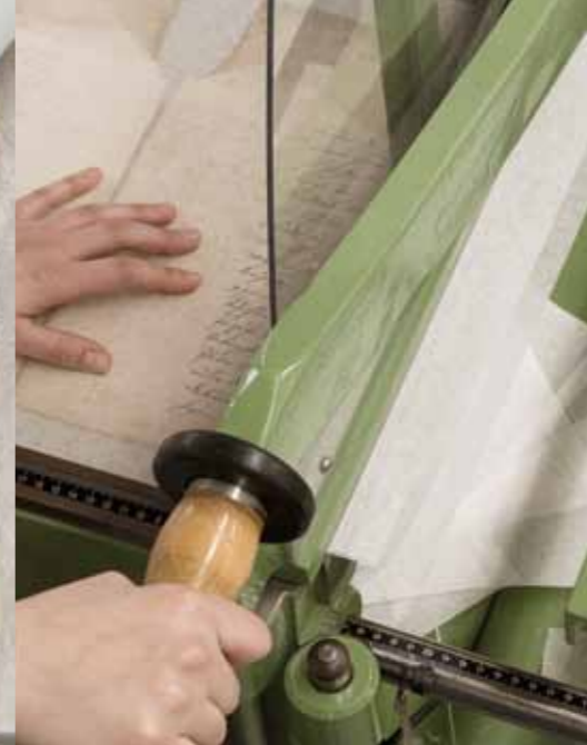
Die überstehenden Ränder der Anfaserung bzw. des Seidenpapiers vom Einbetten werden an der Pappschere beschnitten.
