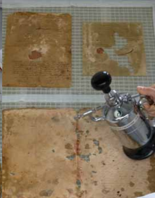
Die Blätter werden auf das Trägersieb aufgelegt und mit einem Wasser-Alkohol-Gemisch besprüht, damit sie besser Wasser aufnehmen.
