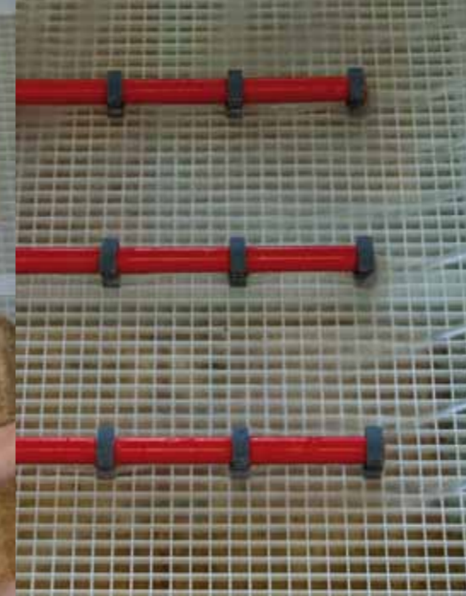
Dann wird die Faserstoffsuspension auf die mit einem Schutzgitter abgedeckten Blätter gepumpt.
