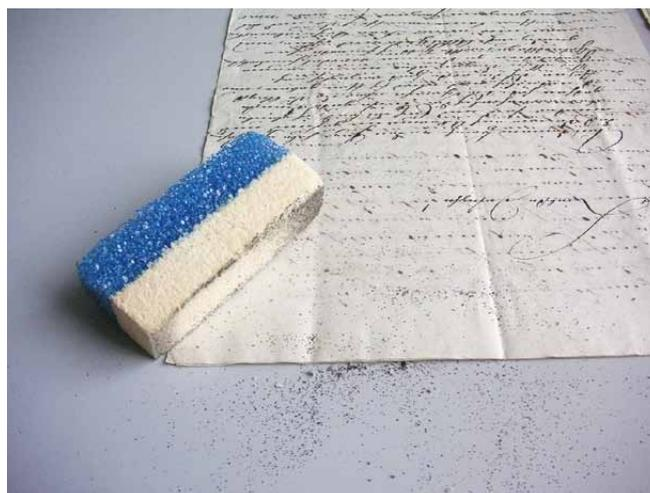
Entfernung von Streusand bei der Trockenreinigung von Archivbeständen
