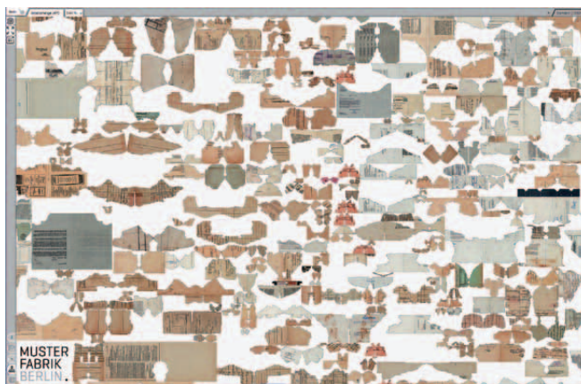
Beidseitige Anzeige digitalisierter Fragmente im Rekonstruktions-Assistenzsystem; exemplarischer Ausschnitt mit ca. 300 Fragmenten (Foto: © MusterFabrik Berlin)
