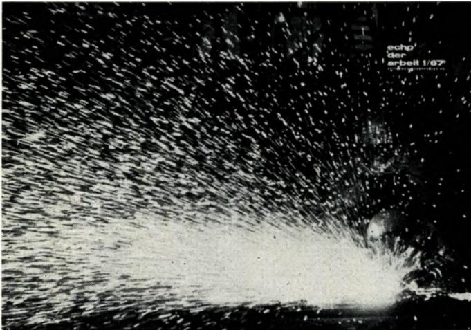
Flämmer bei der Arbeit. Beim Flämmen werden Oberflächenfehler des Halbzeugs durch flachgestellte Schneidbrenndüsen entfernt. Man kann dazu ein Handgerät oder auch eine Flämmaschine benutzen.
