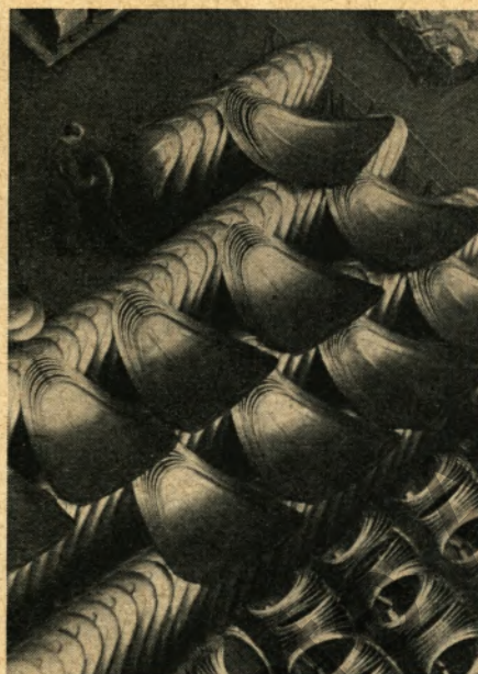
Wie Ton in der Hand des Töpfers wandelt sich das Stahlblech unter dem unwiderstehlichen Druck gewal- tiger Pressen in vielgestaltige Karosserieteile.
