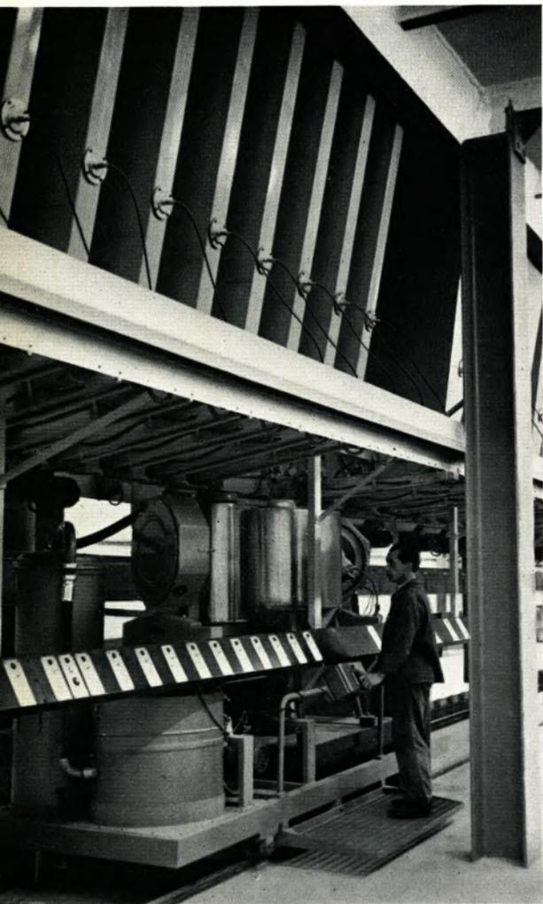
Über 50 verschiedene Sorten Schweißelektroden stellt das Schwerter Unternehmen her. Die spezifische Eigenart einer Schweißelektrode wird im wesentlichen von der Umhüllungsmasse bestimmt. Die Zusammensetzung der Umhüllungsmasse ist darum von ganz besonderer Wichtigkeit. Aus einer Dosieranlage werden die Rohstoffe — genau nach
