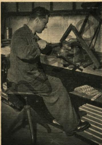
Nach einer Granatsplitterverletzung verlor Walter Pudwall in Rußland den rechten Oberschenkel. Für ihn wurde unterhalb der Feilbank ein Rost angebracht, was ihm ermöglicht, die Prothese aufzustützen und die Arbeiten im Sitzen auszuführen.
