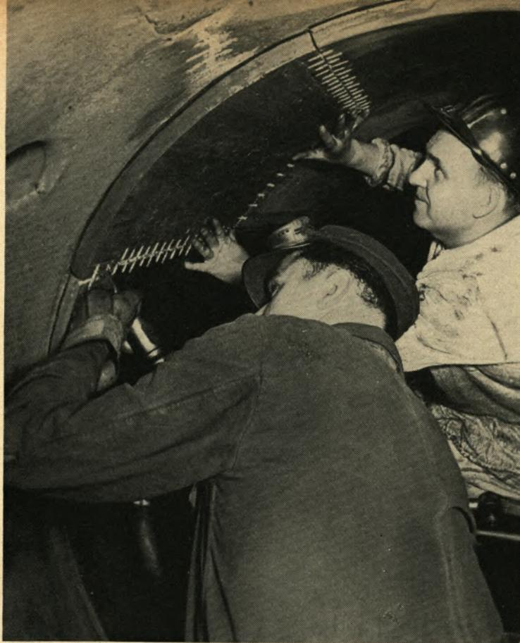
▲ In den rissig gewordenen Zylinder eines Gasdynamos im Maschinenhaus 1 der Eisenhütte wurde soeben eine neue Platte eingesetzt. Sie ist 40 Pfund schwer und wird nun dicht „vernäht“. Willi Lücke vom Maschinenhaus (rechts) ist einem Monteur der Spezialfirma, von der die Arbeiten ausgeführt werden, dabei behilflich. Die Verriegelung der eingesetzten Platte ist auf unserem Bilde wie eine Naht deutlich erkennbar.
