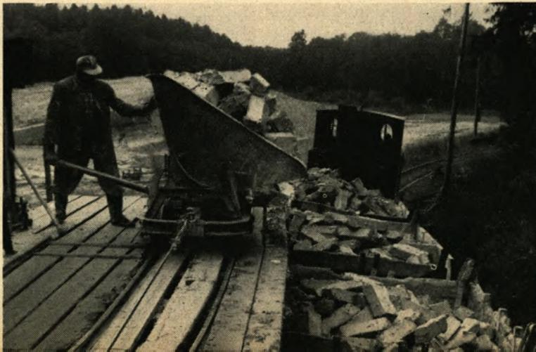
Seilwinden ziehen die vollen Loren aus der Grube auf eine Verladerrampe. Von hier gelangen die Tonschollen in Grubenwagen zur Ablagerung in große Schuppen.
