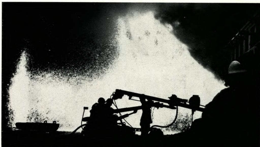
belstapler über eine Schrägrampe auf die Konverterbühne und vor den Konverter transportiert wurde. Das Zusetzen von Si, Al und S in die Gießpfannen geschah manuell.
