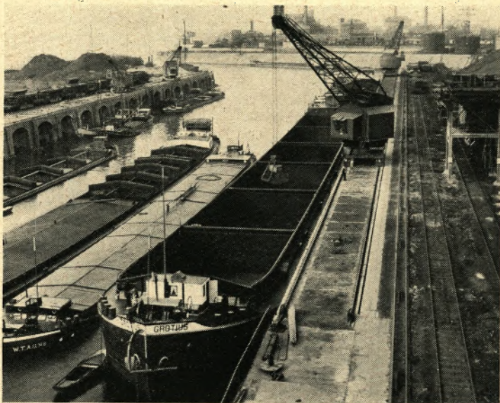
„Grotius“, ein niederländischer Schleppkahn, brachte kürzlich 4200 Tonnen Kiruna-Erz von Rotterdam nach Walsum. Es ist der größte Schleppkahn, der auf dem Rhein fährt. Bei einer Länge von 130 Metern und 15 Meter Breite hat der Kahn einen Tiefgang von 3,25 Metern. Er verkehrt rheinaufwärts nur bis Duisburg.
