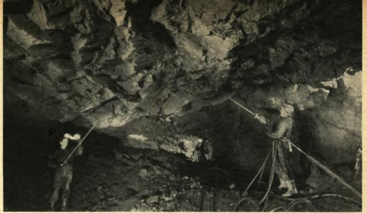
▲ In etwa fünf Jahren wird die gesamte Förderung in Kiruna unter Tage erfolgen. 1953 entfielen auf den Tagebau noch neun Zehntel der gesamten Produktion, während der Rest im Untertagebau gefördert wurde. Leistungsfähige Bohraggregate haben die vor einigen Jahren noch vorherrschenden alten Abbauhämmer ersetzt.
