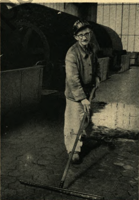
▲ Wilhelm Mateja von der Filteranlage bastelte einen „Alles-Schrubber“: nur ein Stück Bandeisen, einen Gummistreifen und einen Holzstiel brauchte er dazu. Der Schrubber — so unscheinbar er auch aussieht — hat sich gut bewährt und erspart Putzmaterial. Abgesehen davon wird die Arbeit auch erleichtert.
