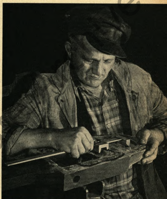
▲ Gerhard Rehfeld aus der Eisenbahnwerkstatt entwarf eine neue Meßlehre, die in ihrer Ausbildung die Form der Kupplungsgelenke berücksichtigt. Der umständliche Vorgang beim Anzeichnen der Bohrungen für die Kupplungsgelenke wurde so vereinfacht. Außerdem wurde die Meßgenauigkeit vergrößert.
