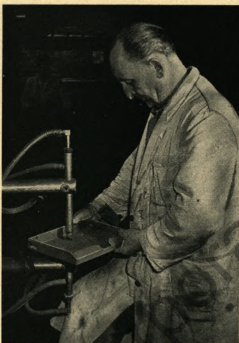
▲ Viel Zeit wird nun beim Befestigen der Nägel in den Zettelkästen der Güterwagen gespart. Nach dem Vorschlag von Schlosser Alois Schwarz werden die Nägel mit Hilfe der Punktschweißmaschine befestigt. Früher mußte in das Blech ein Loch gebohrt, der Nagel hineingesteckt und dann vernietet werden.
