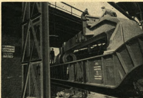
▲ Auf Spezialtransportwagen der Bundesbahn gelangten die Walzenständer nach Oberhausen. Um den Antransport überhaupt zu ermöglichen, mußte bei der Gleiseinfahrt WO eine ganze Brücke der Werksbahn um genau 60 Zentimeter gehoben werden.
