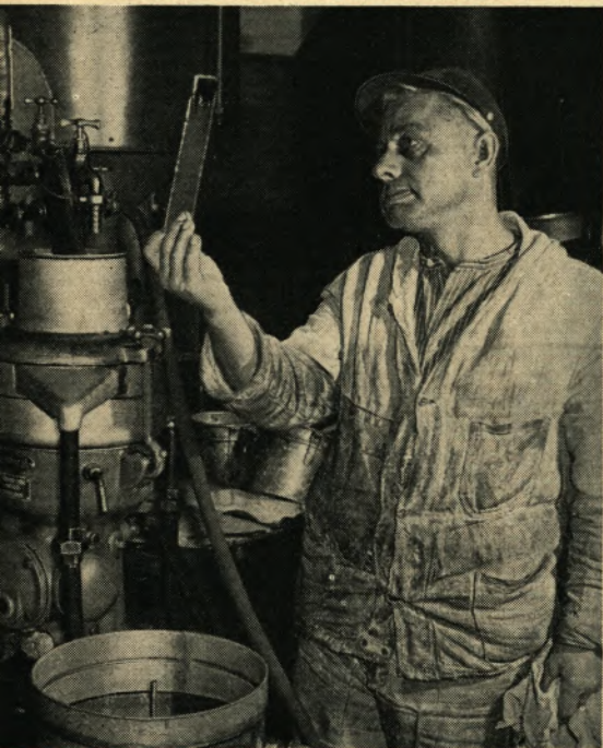
▲ Franz Schumbrink hat sich die Ölschneidung aufs Korn genommen. Durch seinen Vorschlag wurde sie wesentlich vereinfacht. Man baute einfach in die Ölseparation ein zusätzliches, vier Sieben bestehendes Vorschaltfilter ein. Es ist nun nicht mehr erforderlich, daß das Öl mehrmals durch die Separation läuft. Ein wenig Überlegung könnte noch vieles verbessert werden.
