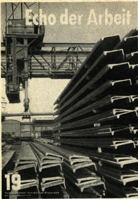
Einen großen Anteil an unserem Walzprogramm haben die Lieferungen für den in- und ausländischen Schiffbau. Neben den Schiffsblechen sind es die verschiedenen Spezialprofile, die in allen verlangten Abmessungen hergestellt werden. Unser Titelbild zeigt zum Beispiel Winkelwulststahl. Das gesamte Schiffbaumaterial unterliegt vor jeder Auslieferung einer sorgfältigen Abnahmekontrolle durch die dafür zuständigen Schiffsklassifikations-Gesellschaften.
