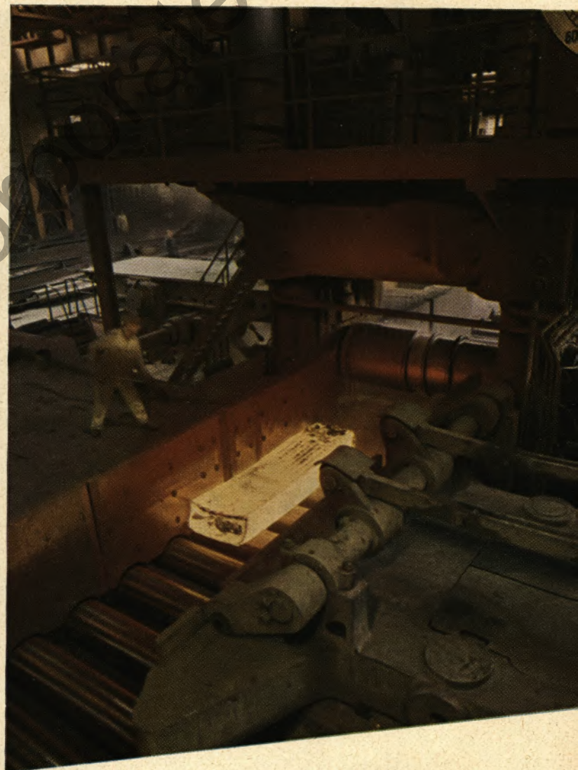
Blick in das „Hirn“ des Blockwalzwerks, wie man vielfach die Steuerbühne bezeichnet. Von hier aus wird die Arbeit der Blockstraße durch Betätigung von Schalthebeln und -knöpfen wie von Geisterhand dirigiert. Die Anlage ist auf den modernsten Stand der Technik gebracht; wo früher die Walzmannschaften schwerste körperliche Arbeiten leisten mußten, genügt heute der Druck auf einen Knopf.
