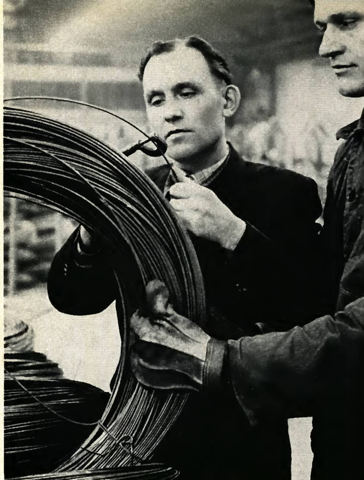
▲ In den Betrieben unseres Werkes Gelsenkirchen sind gegenwärtig über 34 Meister beschäftigt. Unser Bild zeigt Meister Anton Breuer vom Stahldrahtzug, wie er mit einem Mikrometer die Stärke eines Drahtes nachmißt.
