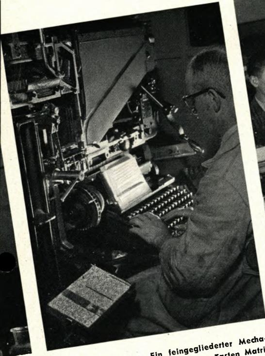
An der Setzmaschine. Ein feingegliedertes Mechanismus löst durch das Anschlagen der Tasten Matrizen aus und führt sie vor den Gießmund, wo die Zeile in Blei gegossen wird. Links an der Maschine erkennt man den ausgeworfenen fertigen Satz.
