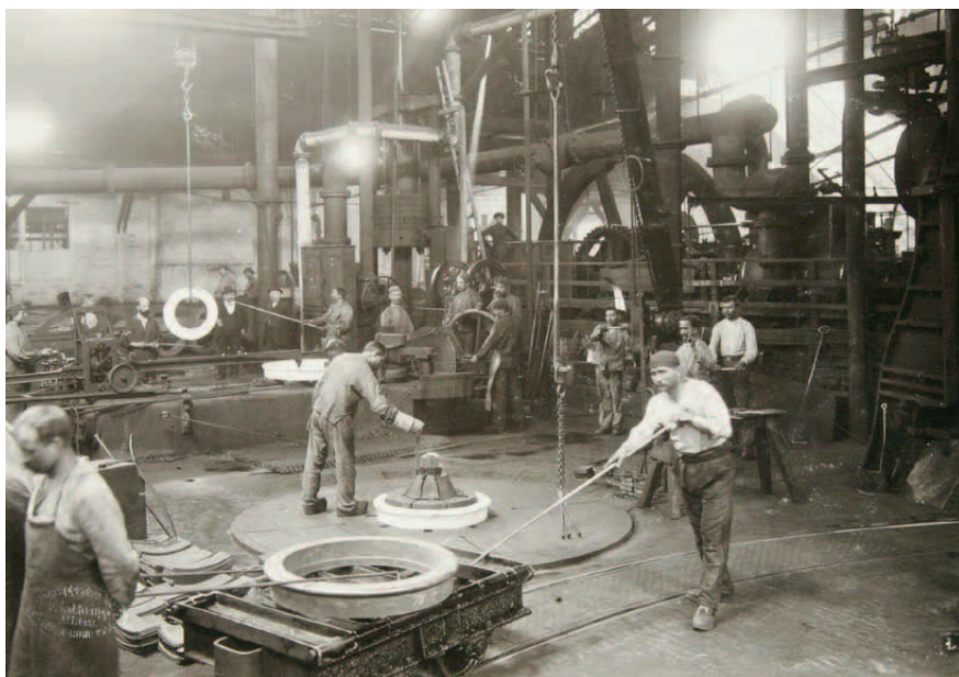
Radreifenherstellung im Bandagenwalzwerk II, Essen, 1906. Chlorsilbergelatinepapier, 17,2 x 28,9 cm / 31 x 40 cm, aus dem Album „Fried. Krupp A.G. Gußstahlfabrik Essen/Ruhr“ (WA 16 b 203.18)
